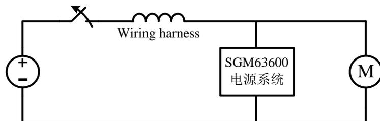
图 12 Pulse 2b 产生电路框图<sup>[2]</sup>
